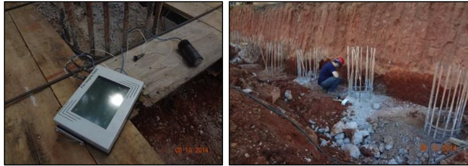
Figura 8. Equipo para captación y visualización de señales (izq.) y ejecución de ensayo in situ (der.).
